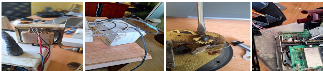
Зураг. Зэрэг өртөөний CAMS-620 2024 оны 03 -р гэмтэл гарч ажиллахгүй болсон. Логерийг төвд авч ирж засварлаж хэвийн ажиллуулж байна , 4-н салбарын цагийн
