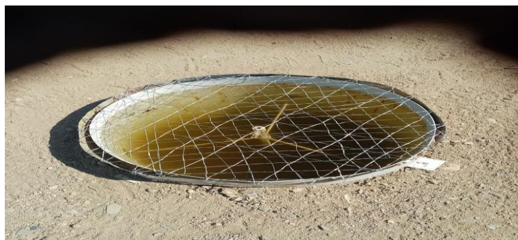
Зураг-2. Ууршуулалтын ГГИ-3000 багаж суурилуулсан байдал.
